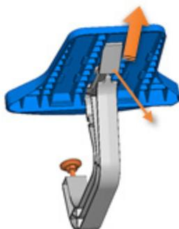
Para desmontar: tirar hacia fuera de la pieza del extremo del brazo y deslizar el brazo separándolo de la superficie de apoyo.
