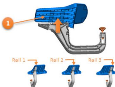
Alinear el extremo del brazo multi-posición en su alojamiento en la parte inferior de la superficie de apoyo (en posición izquierda, central o derecha).
