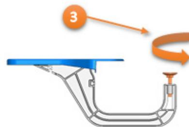
Girar el tornillo de sujeción hasta ajustarlo al grosor de la mesa.
